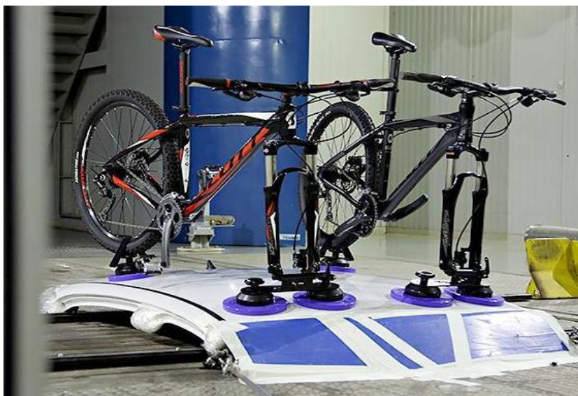
Figura 3: Teste em túnel de vento do rack LevaBike.
