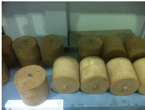
Figura 1: Corpos de prova de geopolímero (AG).
