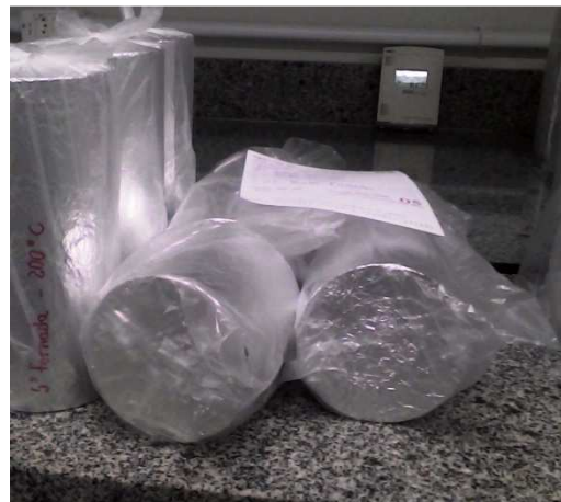
Figura 5: Corpos de prova embalados após ensaio de alta temperatura
