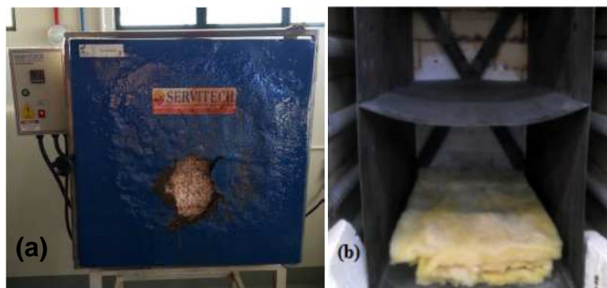
Figura 4: Forno mufla Servitech (a); Gaiola dos corpos de prova (b).
