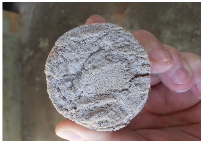
Figura 8: Ruptura da argamassa PC28 com fissuras.
