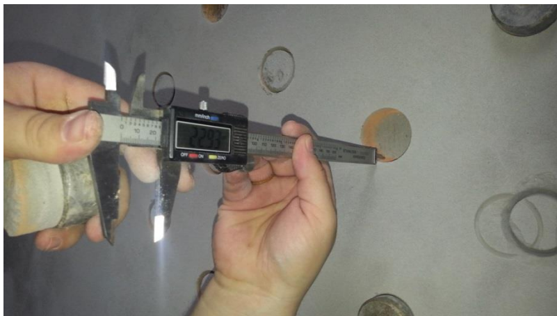
Figura 4: Espessura do revestimento.
